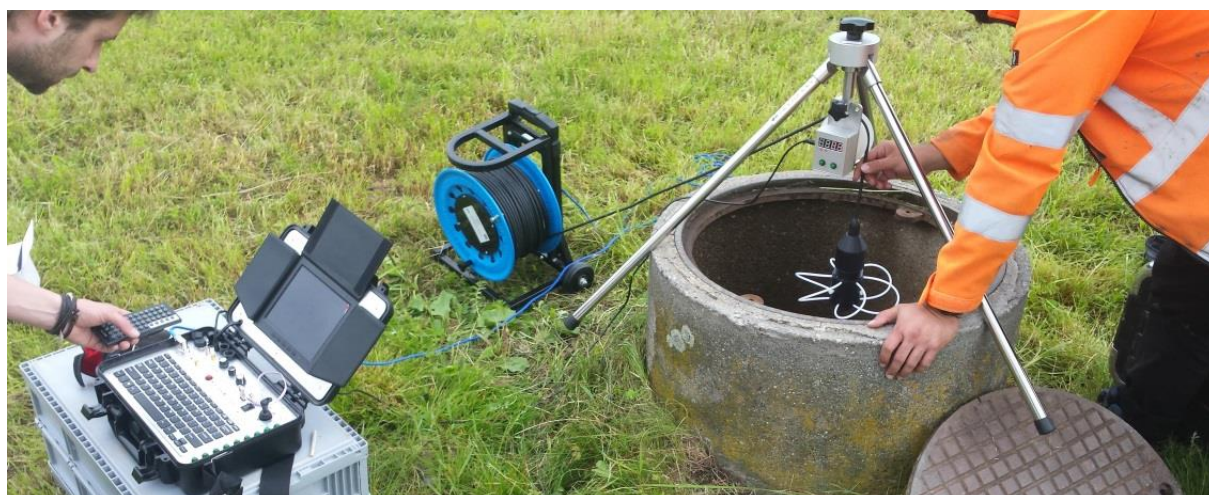
FIGURE 4 – MOYENS DE SURVEILLANCE DES NAPPES SOUTERRAINES : LE PIEZOMETRE
